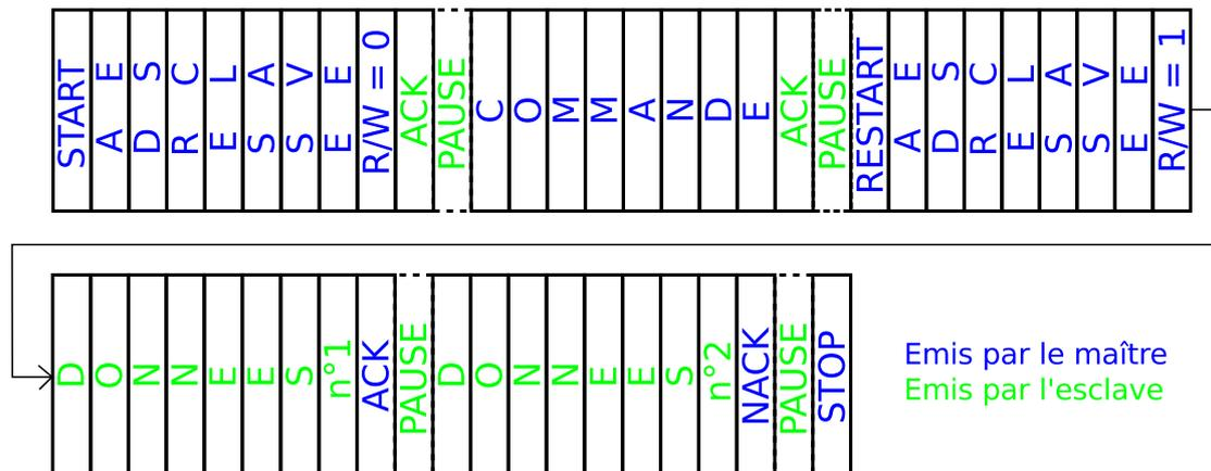
FIG. 2.10. : Exemple d'échange I<sup>2</sup>C entre un maître et un esclave
