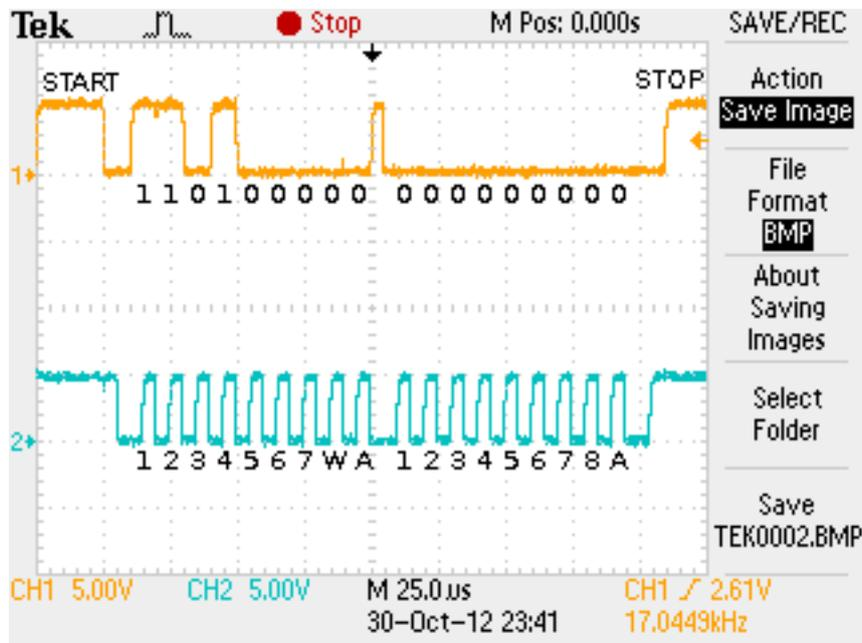
FIG. 5.1. : Écriture d'un 0 à l'oscilloscope
